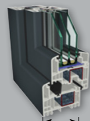
okno w systemie S 9000 uszczelnienie środkowe głębokość – 82,5 mm ilość komór – 6 Uf = 0,92 W/m²K
