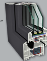
okno GEALAN-LUMAXX z obniżonym skrzydłem system S 9000 głębokość 82,5 mm ilość komór – 6 Uf = 0,99 W/m²K
